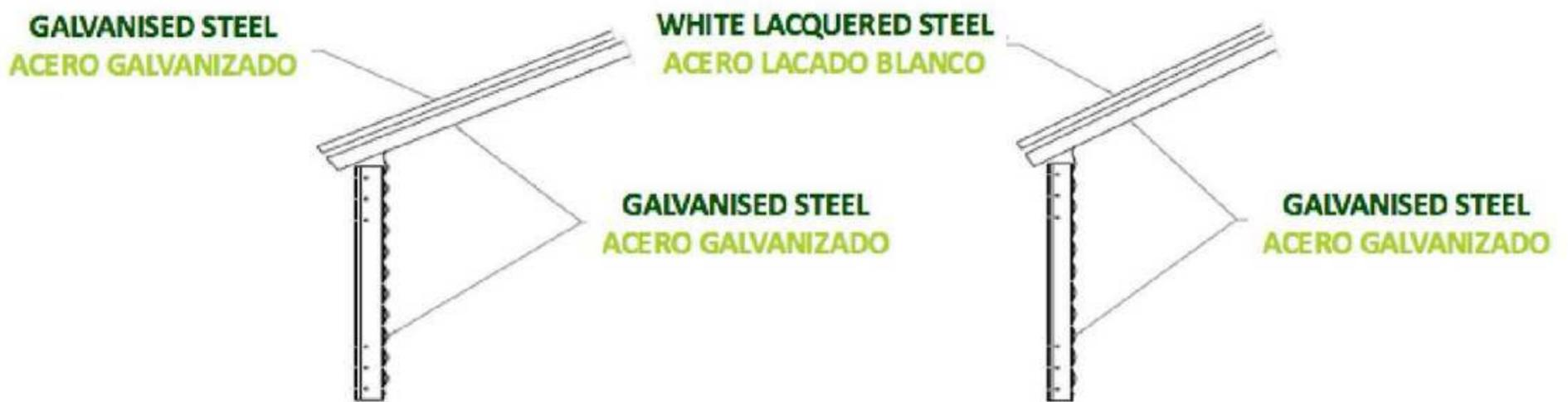
**5. Chapa simple + Techo doble + Material aislante.** Combinación del primer sistema y doble chapa en el techo con material de aislamiento interior.
