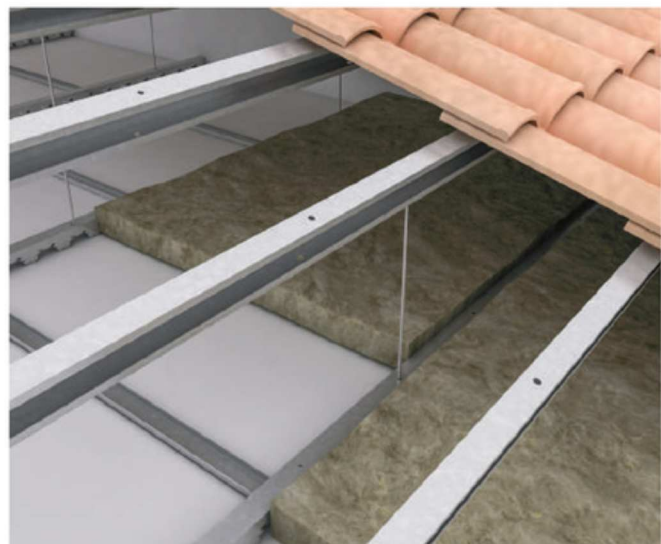
Detalle cumbra y falso techo
